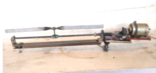
Рисунок 2 — Действующая натурная модель системы механизированной подачи ШОС в кристаллизаторы при литье заготовок особо крупного прямоугольного сечения
