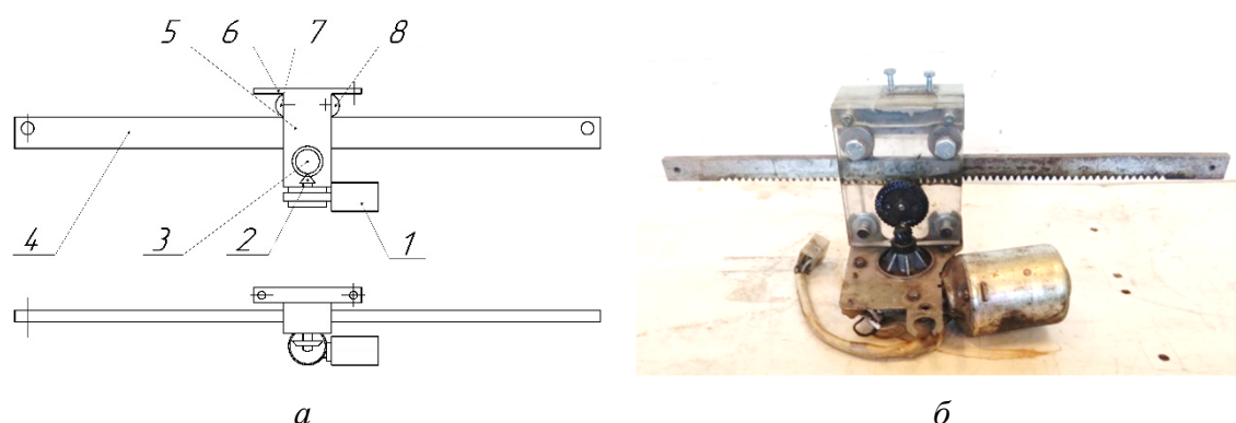
Рисунок 5 — Конструктивная схема (а) и натурное исполнение (б) реечного механизма передвижения тележек
