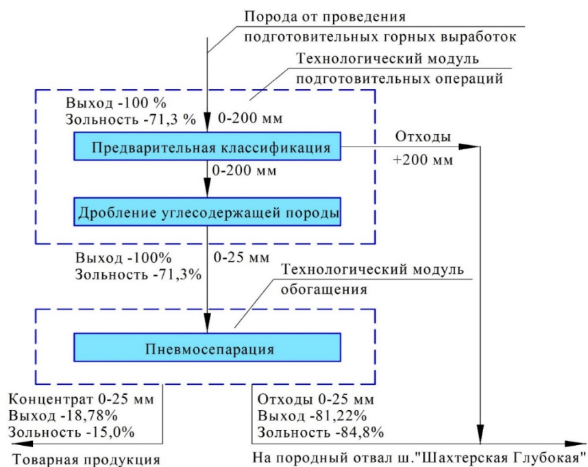
Рисунок 4 — Технологическая схема обогащения шахтной породы по технологии «СЕПАИР» на поверхностном комплексе шахты «Шахтерская-Глубокая»
