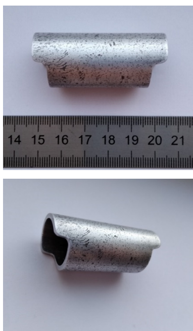
Рисунок 4 — Пример заготовки, построенной по предлагаемой схеме безотходного раскроя ( r_c=3 мм; l_c=7 мм; L_0=50 мм)
