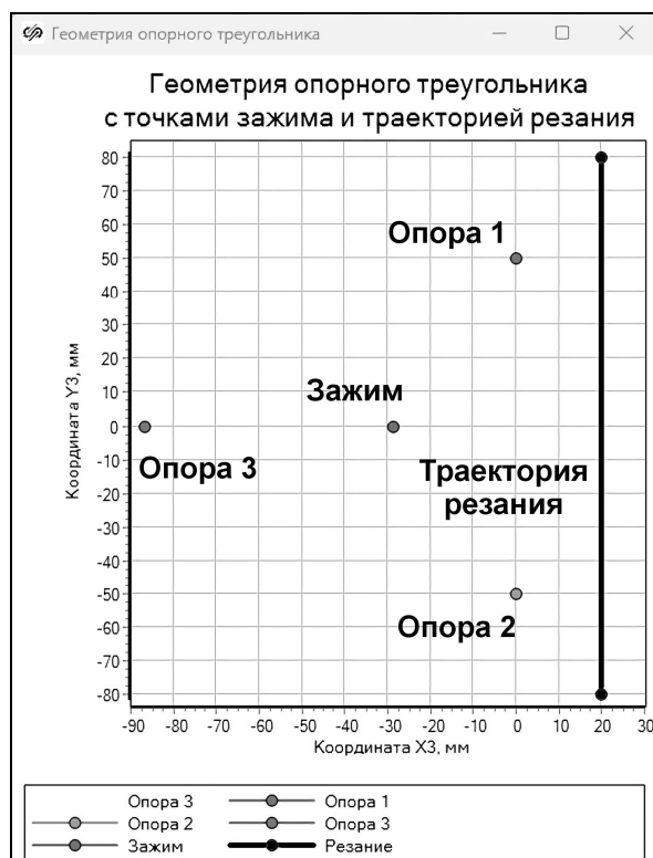
Рисунок 3 — Геометрия опорного треугольника в среде динамического моделирования SimInTech
