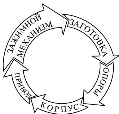
Рисунок 2 — Кольцо силового замыкания станочного приспособления
