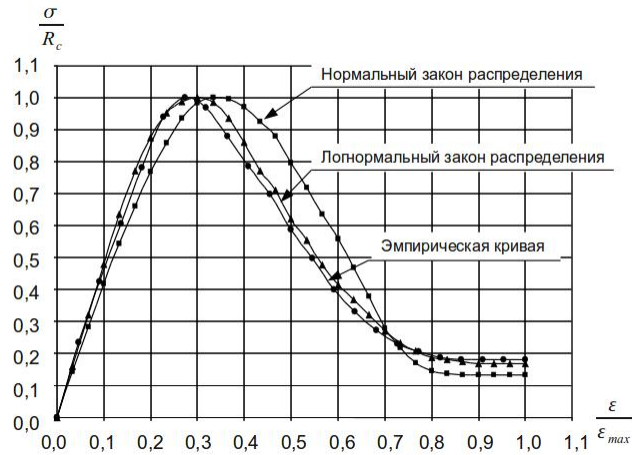
Рисунок 4 – Кривые деформирования за пределом прочности кварцево-гидрогематитобитовитовых сланцев
