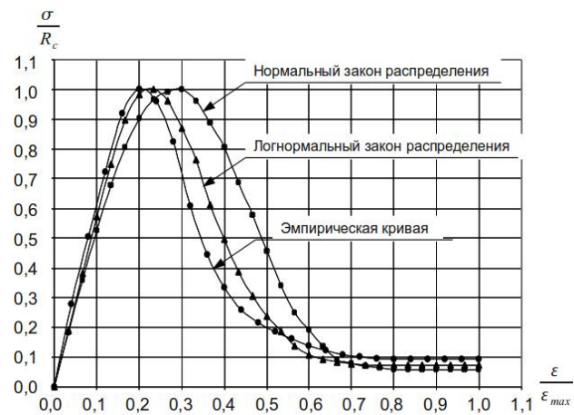
Рисунок 5 – Кривые деформирования за пределом прочности мартито-кварцитогематитовых роговиков
