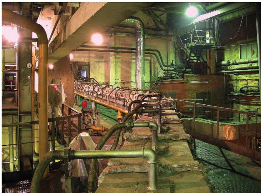
Рисунок 3 – Желоб для транспортировки рафинированной меди
