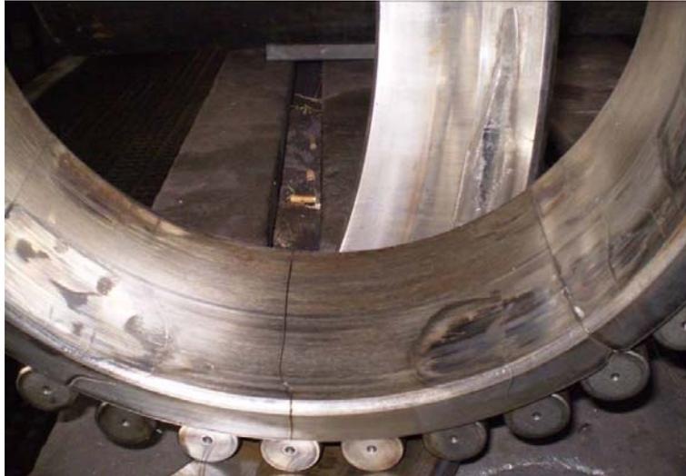
Рисунок 3 – Трещины и следы проворота на посадочной поверхности внутреннего кольца подшипника
