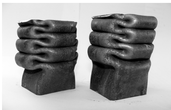
Рисунок 5 – Образцы трубы 40x40x2 после испытаний
