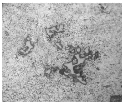
Рисунок 3 Микроструктура после спекания, х500
