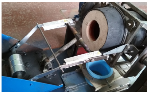
Рисунок 4 Фото моделей кислородного конвертера с двумя осями вращения и системы газодинамической отсечки шлака
