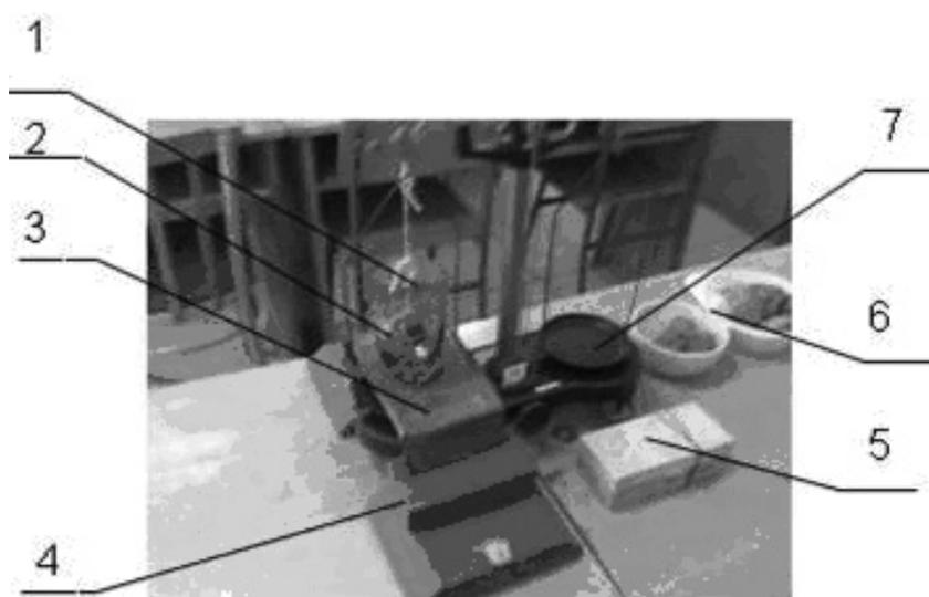
1 — образец из грунта с ниткой; 2 — стакан для воды; 3 — опорный мостик; 4 — подставка для опоры (мостика и стакана) для ограничения прикосновения к чашкам весов; 5 — разновесы; 6 — образцы грунта; 7 — весы лабораторные механические
