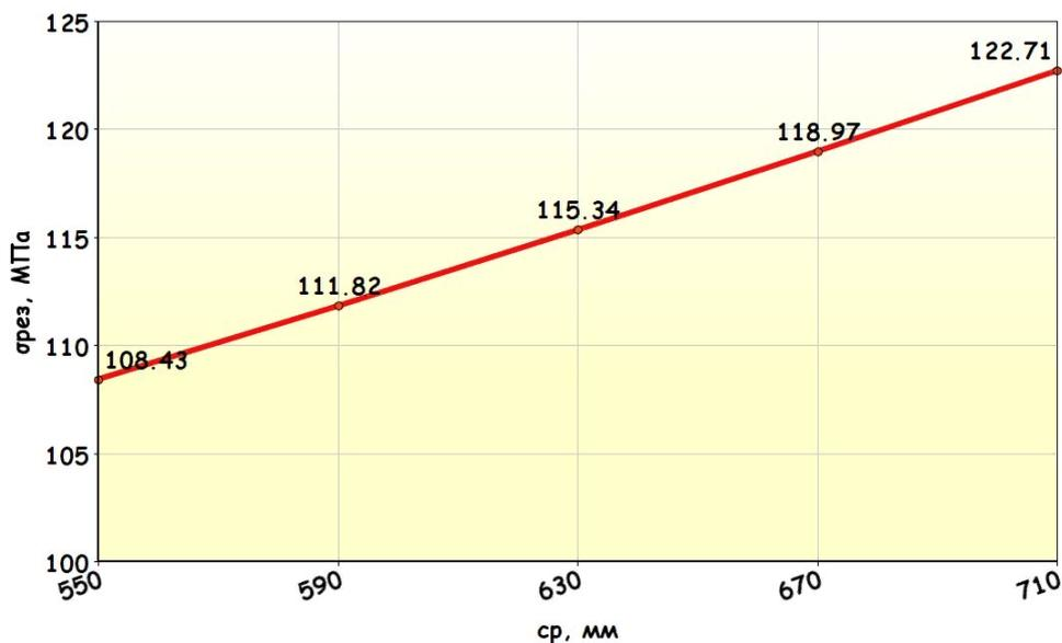
Рисунок 3 График зависимости напряжения  $\sigma_{рез}$  в опасном сечении шейки рабочего валка от плеча  $c_p$  приложения силы противоизгиба
