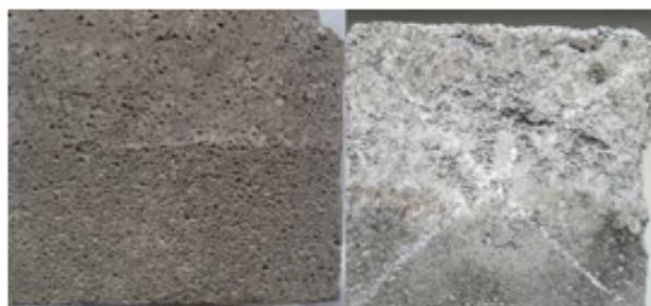
а) — образец газобетона с расходом модификатора 0,5 %; б) — образец газобетона с расходом модификатора 0,8 %.
