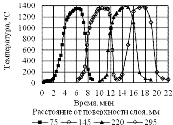
Рисунок 2 Изменение температуры по высоте слоя при спекании агломерата с вводом в пристеночную зону чугунной стружки в количестве: а — 2,5 %, б — 5 %, в — 7,5 %, г — 10 %
