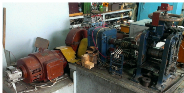
Рисунок 3 Стан 100 прокатной лаборатории кафедры «Обработка металлов давлением»
