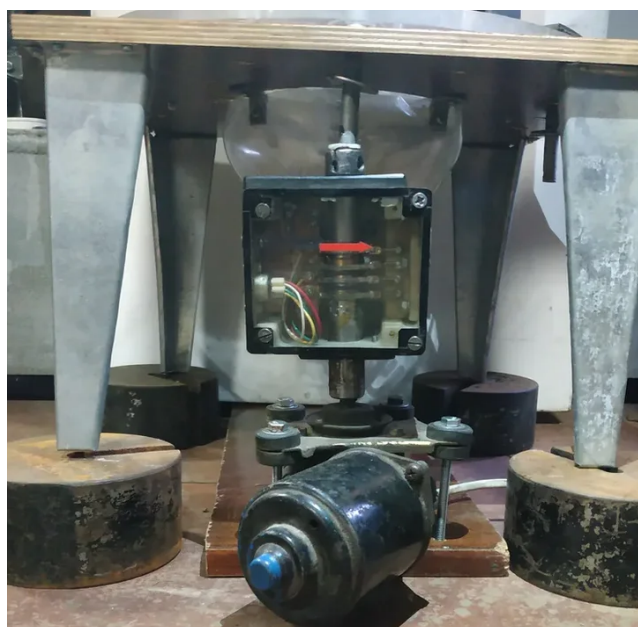
Рисунок 5 Место установки тензорезисторного преобразователя во время проведения контрольных измерений момента сопротивления, преодолеваемого приводом модели выгрузочного устройства
