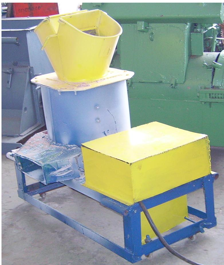
Рисунок 1 Малогабаритный универсальный измельчитель
