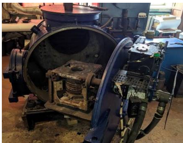
Рисунок 3 Индукционная печь ИСТ-0,01
