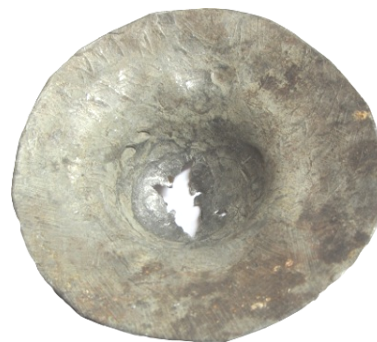
Рисунок 6 Характер разрушения свинцового имитатора перемычки толщиной 0,5 мм под действием избыточного давления, эквивалентного давлению столба жидкой стали высотой 5 м
