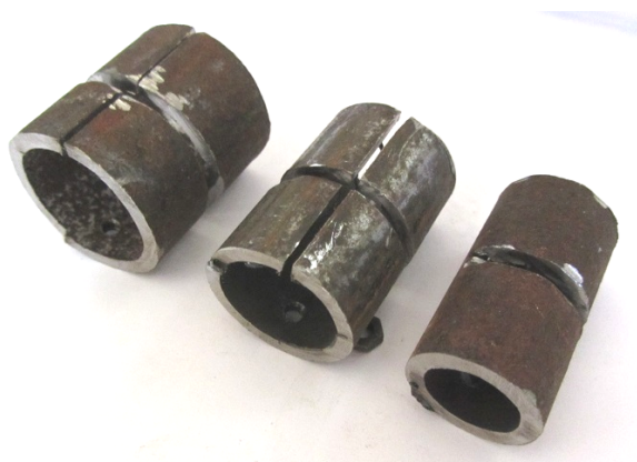
Рисунок 3 Сменный комплект разрезных втулок для фиксации труб различного диаметра на несущей рамке режущего блока
