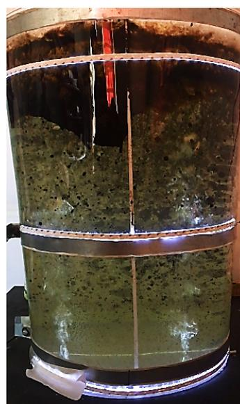
Рисунок 12 Характер перемешивания при расходе газа 28 л/мин
