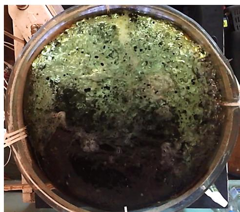
Рисунок 13 Раскрытие зеркала воды при расходе воздуха 28 л/мин
