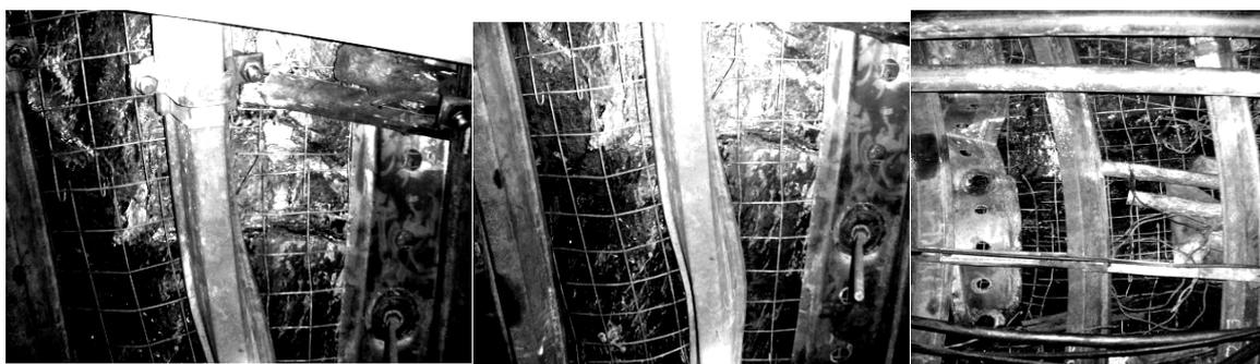
Рисунок 6 – Деформации стоек рамной крепи КМП в виде потери продольной устойчивости и скручивания профиля
