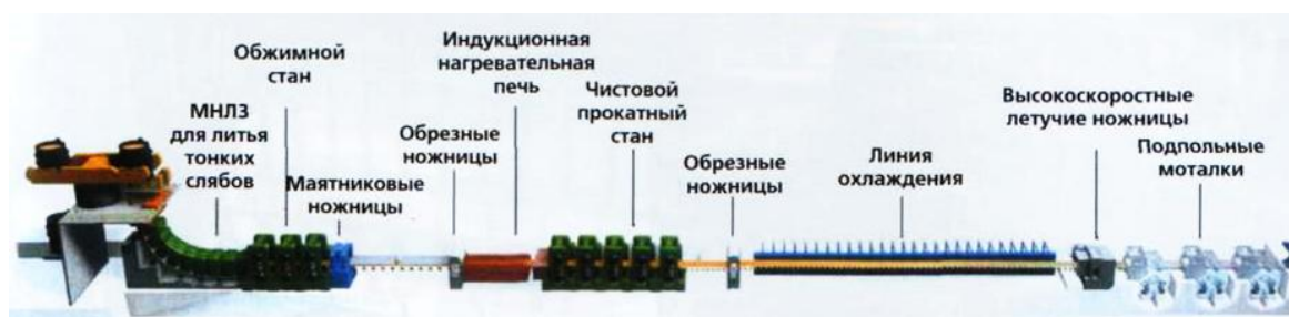
Рисунок 1 – Технологическая схема производства проката на литейно-прокатном модуле
