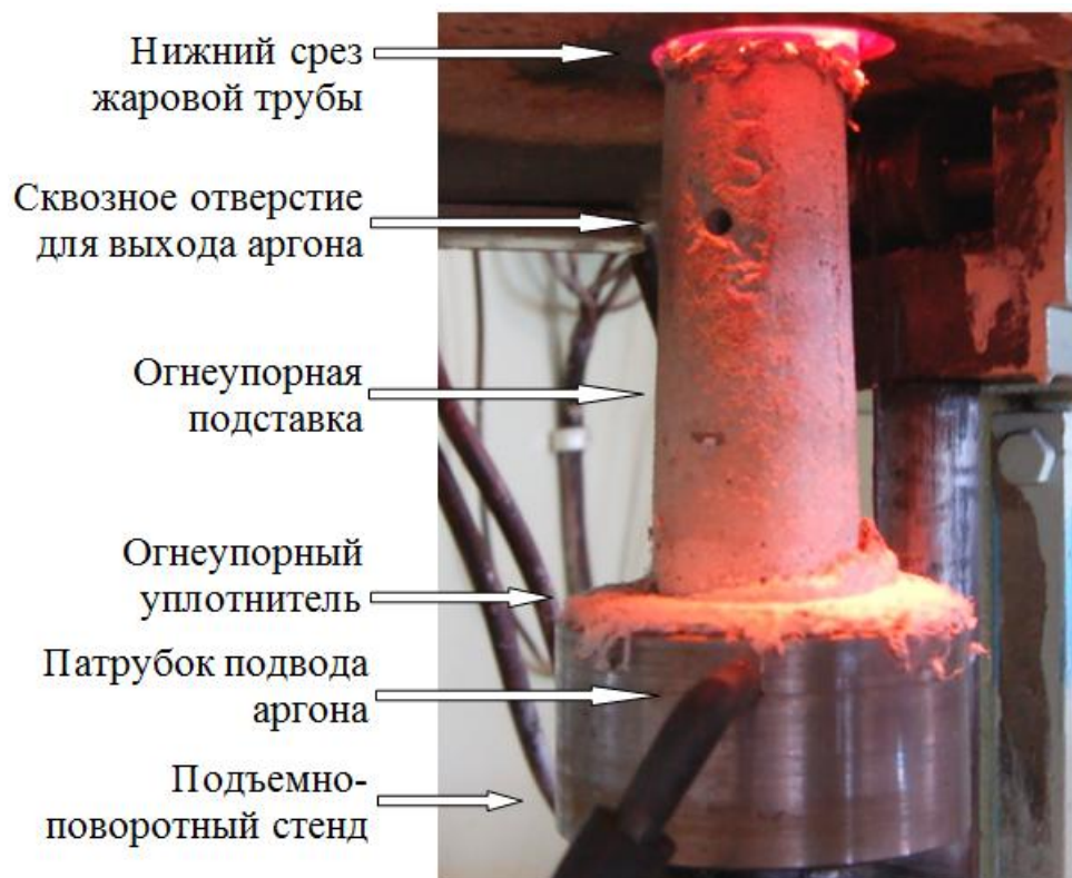
Рисунок 4 – Оснастка для ввода тигля в печь
