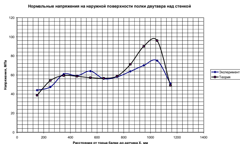
Рисунок 3 – Сравнение экспериментальных и теоретических значений изменения нормальных напряжений на наружной поверхности полки
