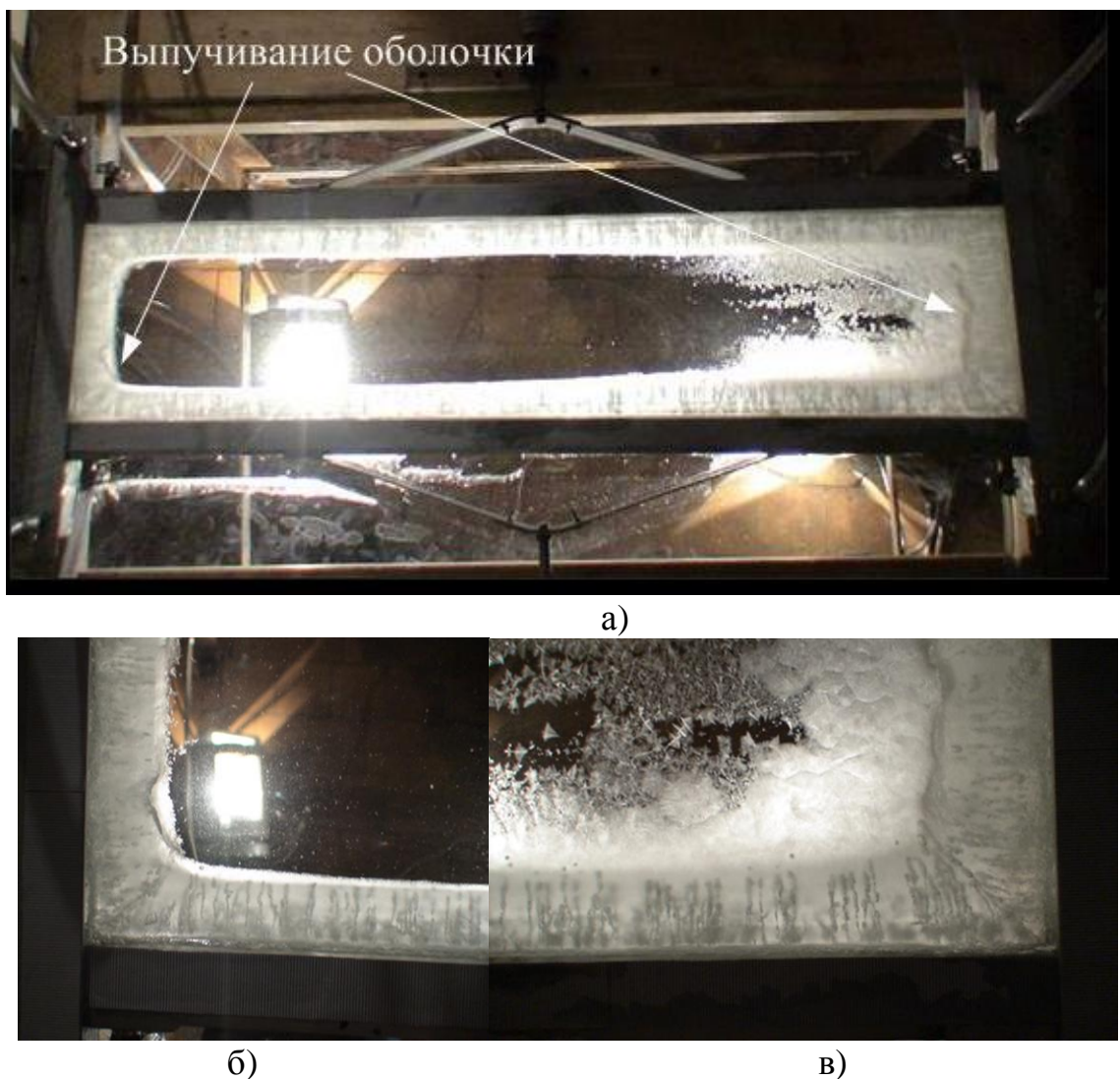
Рисунок 3 – Выпучивание оболочки слитка возле узких граней при обжати на 10 мм (а, б) и характер кристаллизации моделирующего вещества (в)
