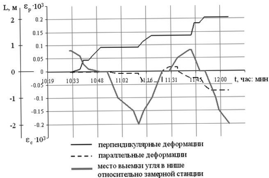
Рисунок 1 – График изменения относительных деформаций в верхней нише 7 западной уклонной лавы пласта l_1
