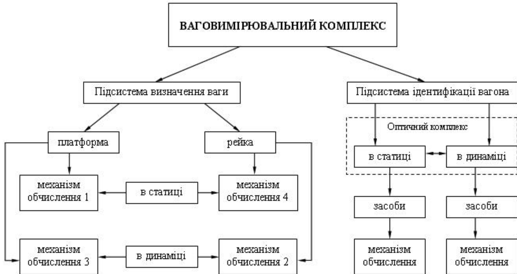
Рисунок 1 – Структурно-логічна схема побудови ваговимірювального комплексу
