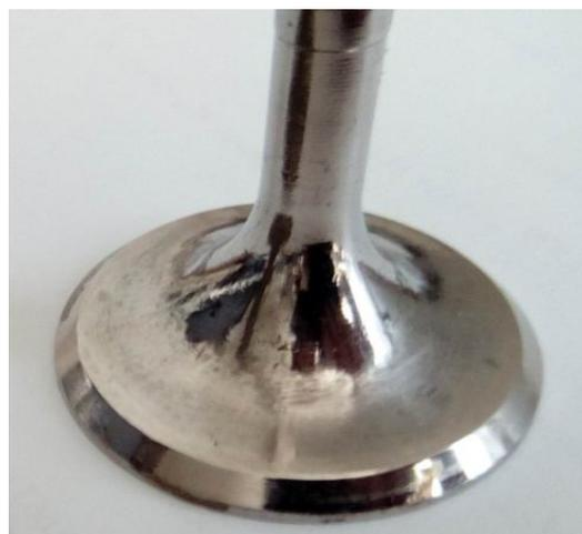
Рисунок 8 Клапан, наплавленный стеллитом и механически обработанный
