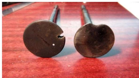
Рисунок 1 Характерный вид раковин прогара клапанов газораспределительного механизма
