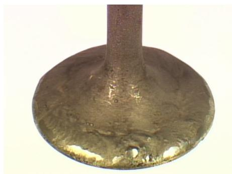
Рисунок 3 Характерный внешний вид клапана после наплавки стеллитом
