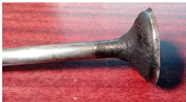
Рисунок 2 Характерный вид дефектов рабочей кромки клапана ГРМ
