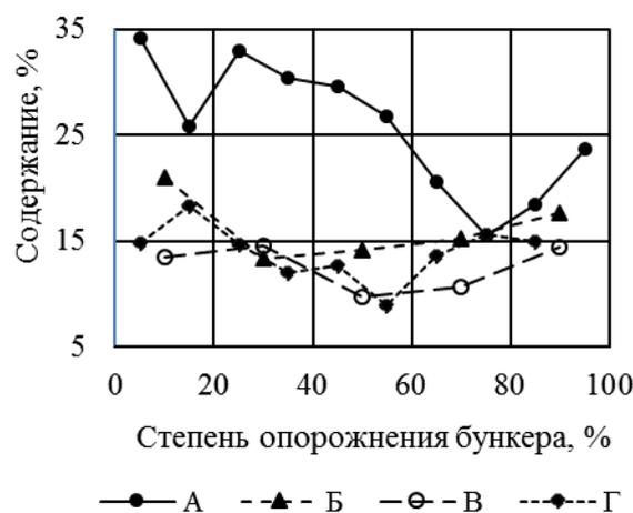
Рисунок 1 Изменение содержания в пробах фракции размером менее 5 мм
