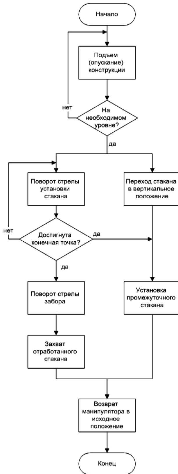
Рисунок 1 Алгоритм реализации системы автоматического управления манипулятором для замены погружного стакана
