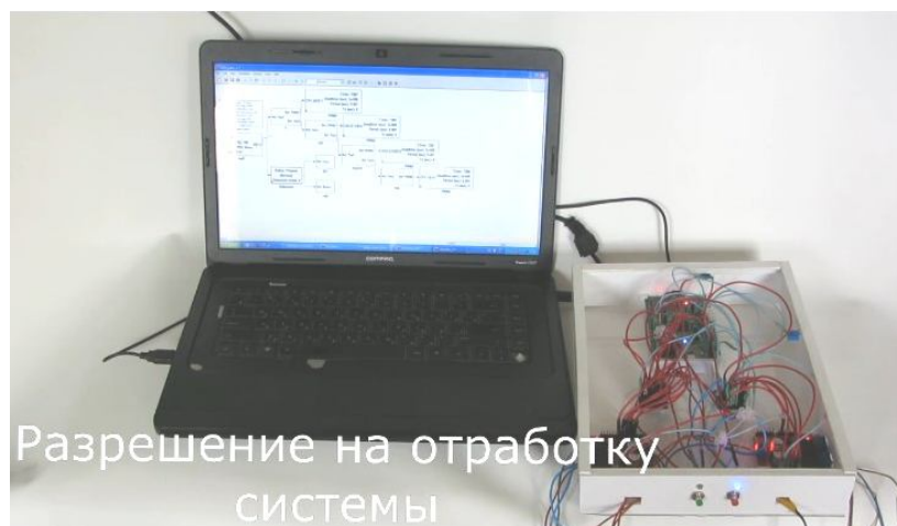
Рисунок 6 Подача команды разрешения на отработку системы БУМ посредством нажатия красной кнопки
