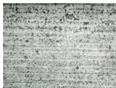
Рисунок 2 Микроструктура стали К60 в исходном состоянии (до ТО), ( \times 500 )
