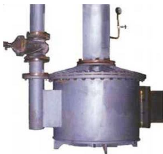
Рисунок 2 Общий вид ГД-фильтра конструкции проф. З. Л. Финкельштейна [8]
