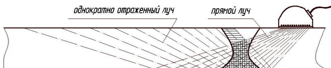
Рисунок 2 УЗ-контроль сварного шва с помощью технологии ФАР
