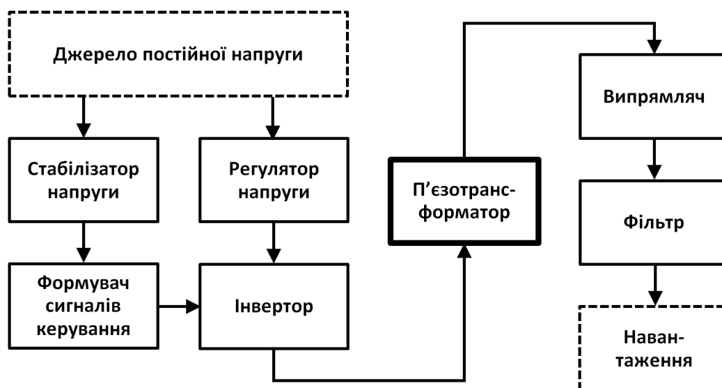
Рисунок 1 – Структура вторинного джерела живлення на основі ПТ
